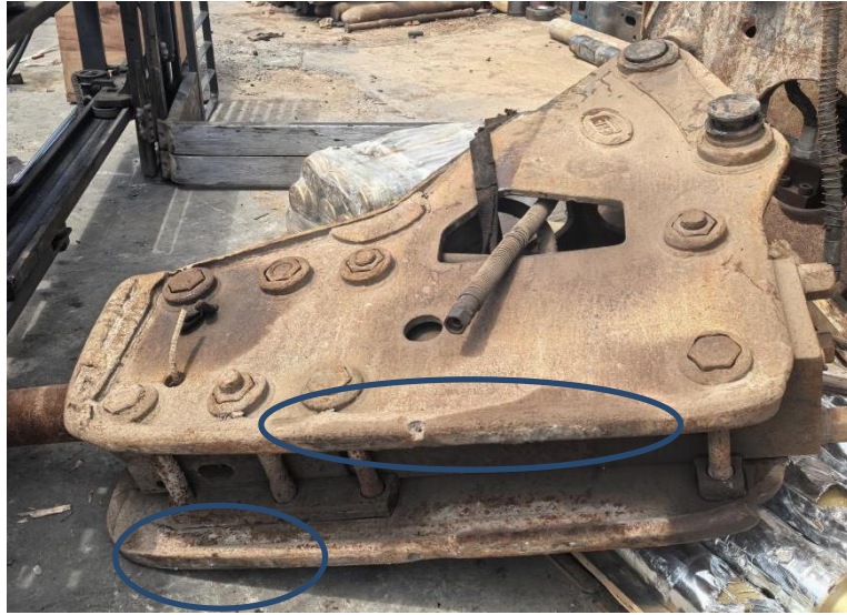
图三 载荷破碎锤底部刮擦的痕迹
